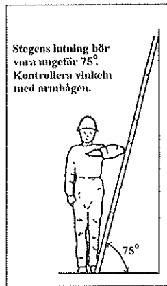
Figur 6. Rekommenderad vinkel vid steguppställning
